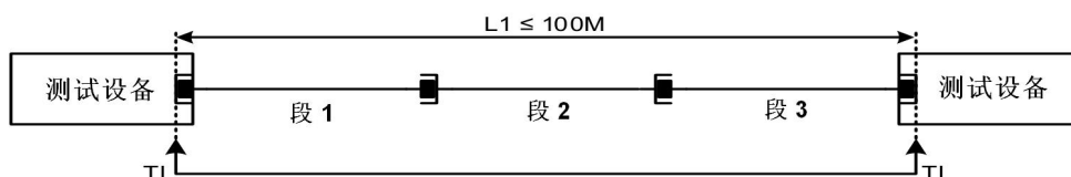
图 A.0.3-6 三段四连接的端到端链路
