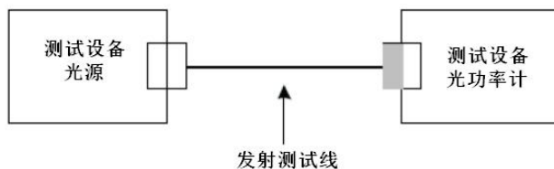
图 D. 2. 3-1 连接 LS-LTC-PM 设置参考
