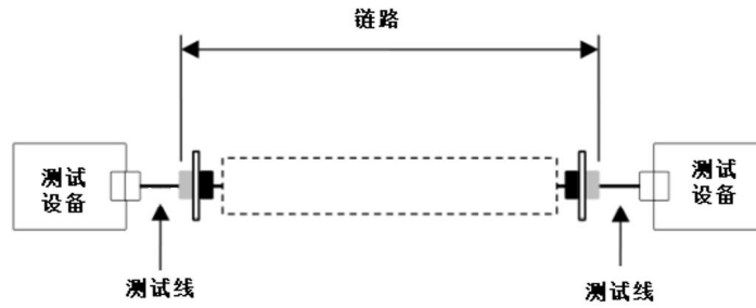
图 D. 2. 1-2 光纤链路测试参考模型
