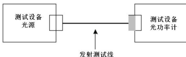
图 D. 2. 3-3 连接 LS-LTC-PM 设置参考
