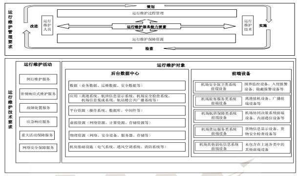
图1 民用运输机场弱电信息系统运行维护体系
