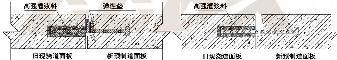
图 7.2.4-1 新旧道面横缝构造图
