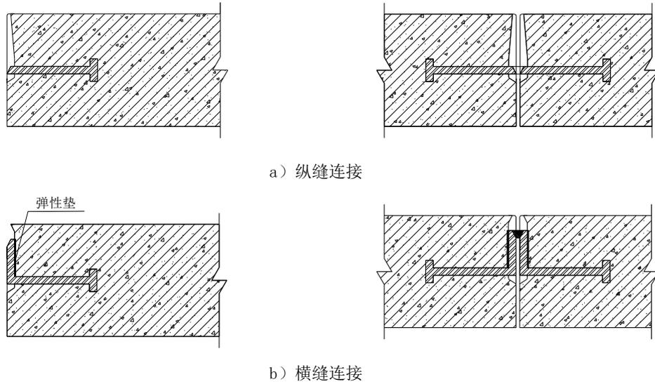
图 5.2.4-2 连接点构造
